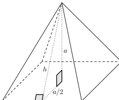
Na figura, está representado o triângulo retângulo formado pela altura da pirâmide, pelo apótema da base e pela altura de uma das faces (também chamado de apótema da pirâmide). Sendo  $a$  a medida das arestas da base (o lado do quadrado) e  $h$  a altura de uma das faces laterais, o triângulo representado tem hipotenusa  $h$  e catetos  $a$  e  $a/2$ .
